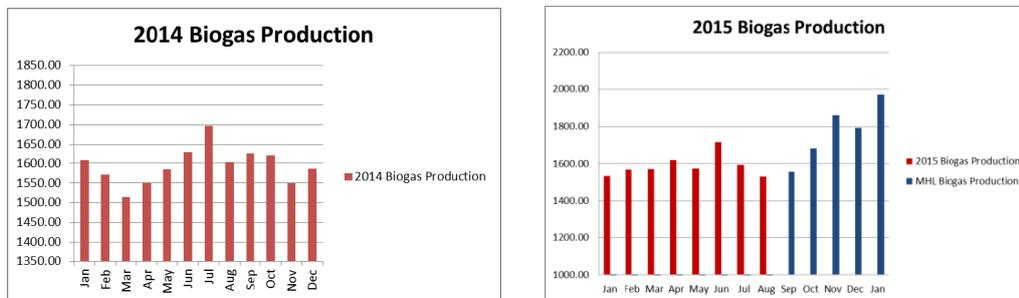
**Figure 2:** 2015 Biogas production per m<sup>3</sup> per day
